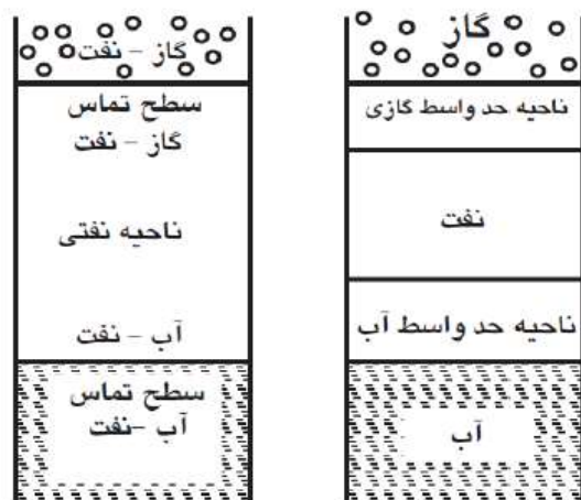
شکل ۷- نمایی از سطوح آب - نفت و گاز - نفت در مخازن معمولی و شکافدار (Perrin, 2017)
